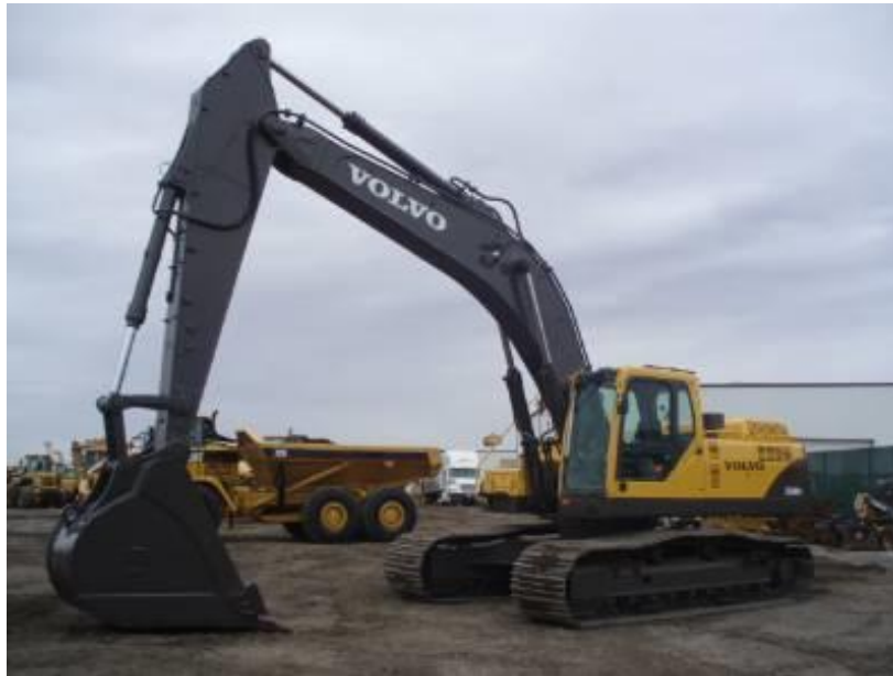
Fotografía 13. Excavadora hidráulica sobre orugas Volvo EC360B
