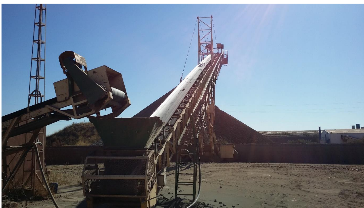
Fotografía 40 . Transportador de banda conectado con la cinta transportadora.
