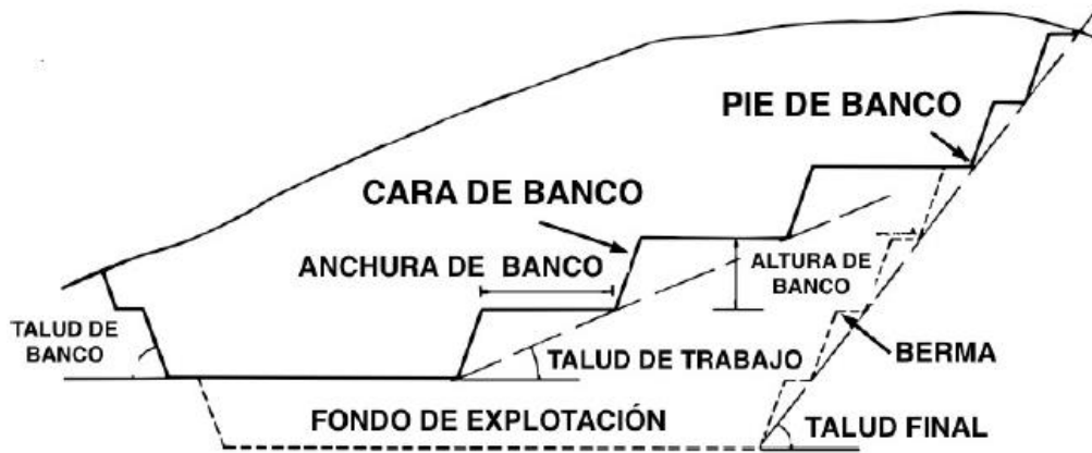
Figura 30. Esquema de cantera. Ángulos de talud.
