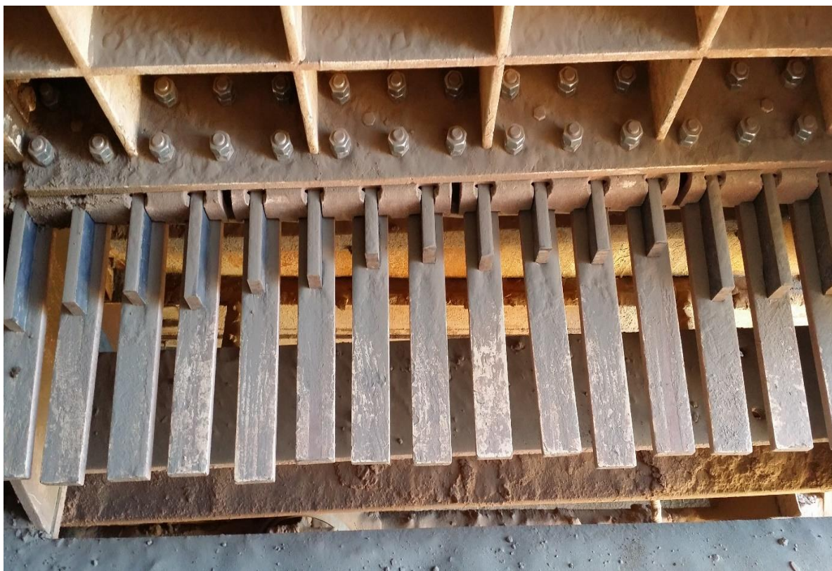
Fotografía 36 . Paletas ajustables para obtener diferente granulometría.
