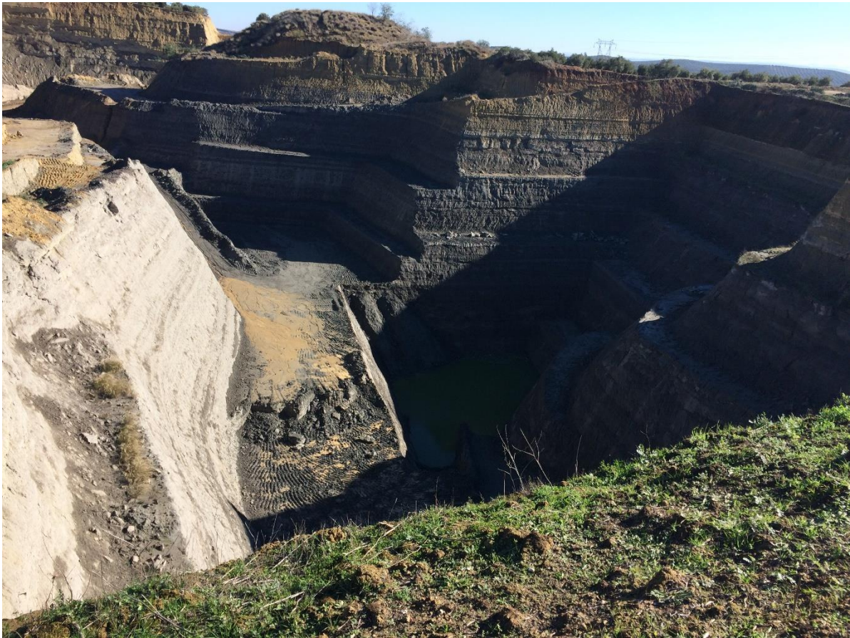
Fotografía 17. Plataforma de trabajo con taludes trabajo y taludes finales.
