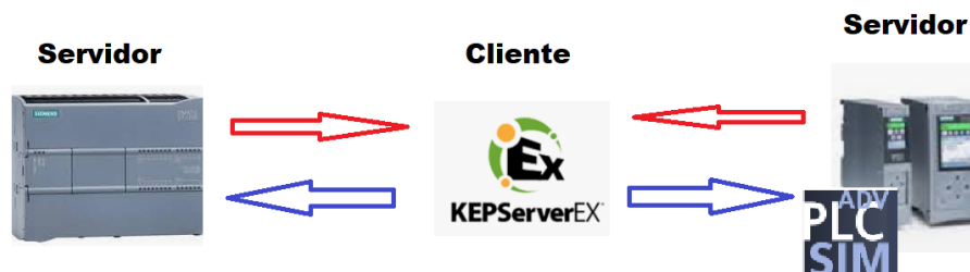
Figura 42 Ejemplo comunicación entre PLC's
