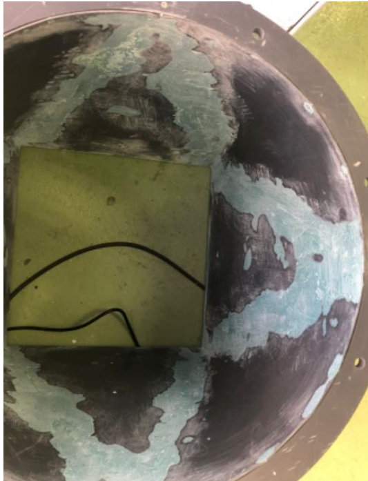
Figura 167. Difusor con material añadido y lijado.
