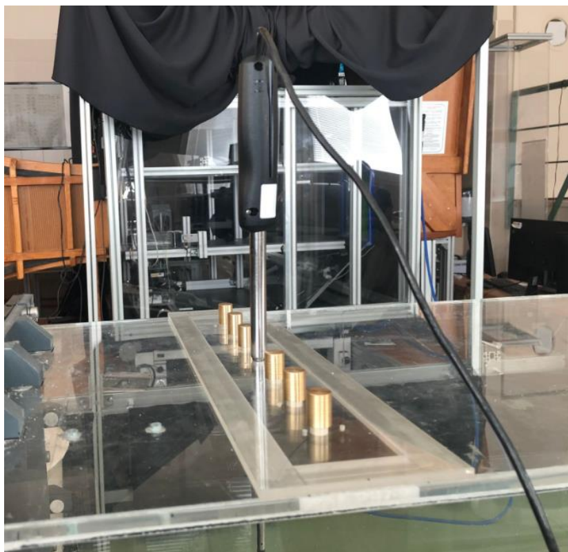
Figura 183. Colocación de varilla del anemómetro de hilo caliente.
