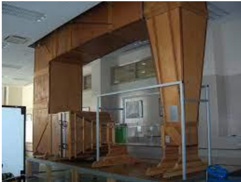
Figura 1. Túnel de viento cerrado de la Universidad de Jaén.
