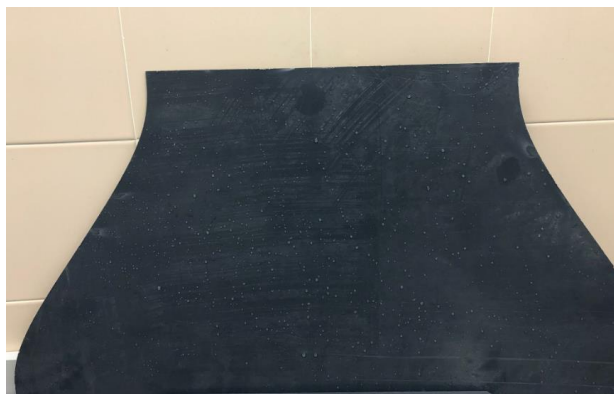
Figura 140. Perfil de contracción plano.
