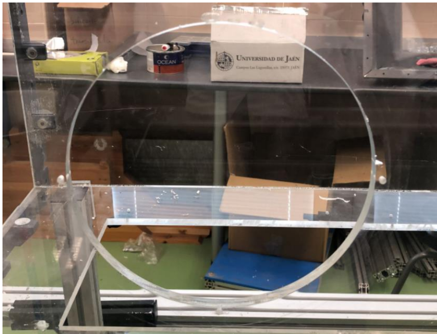
Figura 152. Compuerta lateral de la zona de ensayo.
