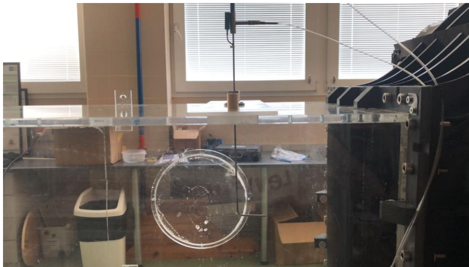
Figura 187. Calibración de túnel de viento con tubo de Pitot.
