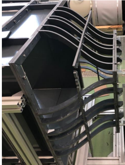
Figura 143. Estructura de la tobera finalizada.
