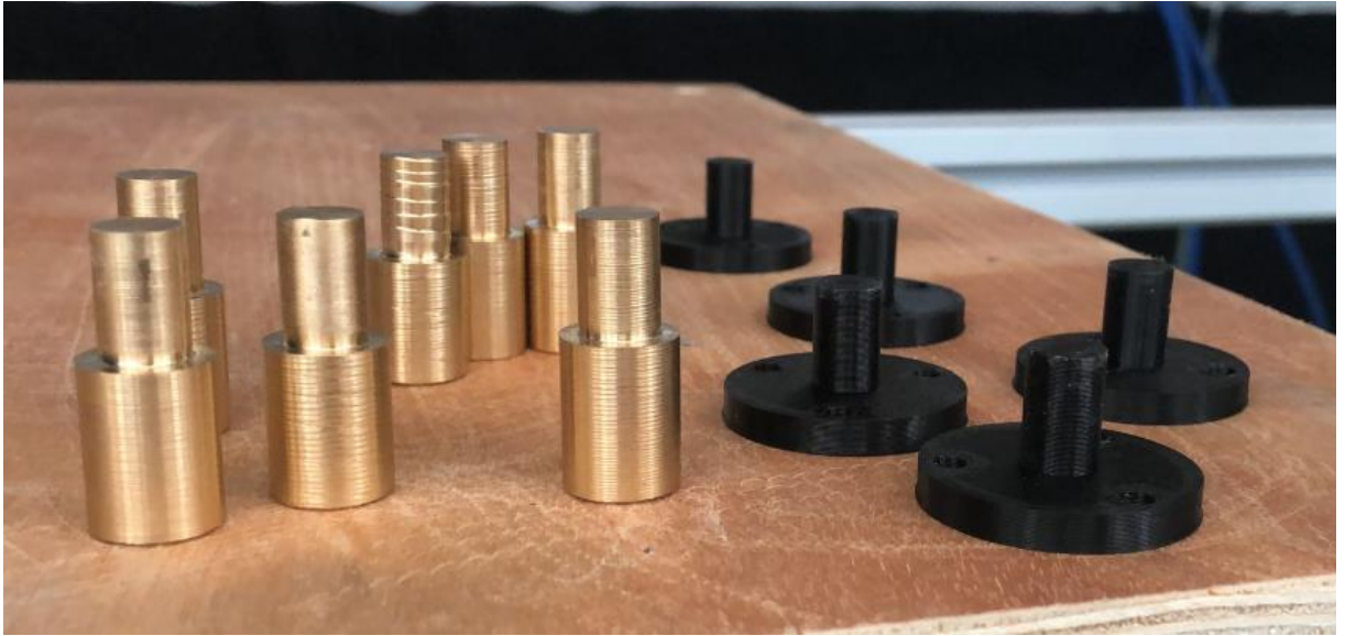
Figura 157. Tapones de los agujeros de las compuertas.
