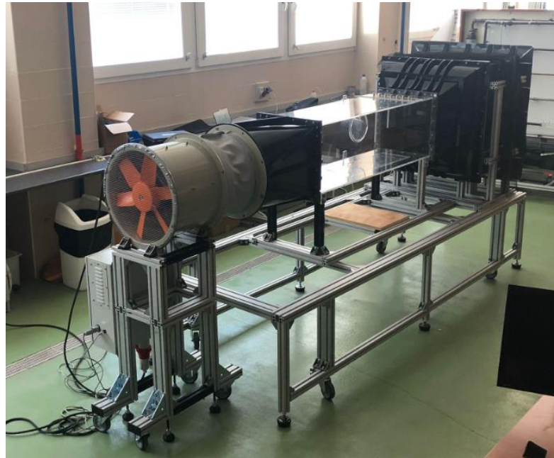
Figura 123. Túnel de viento finalizado. Vista posterior.
