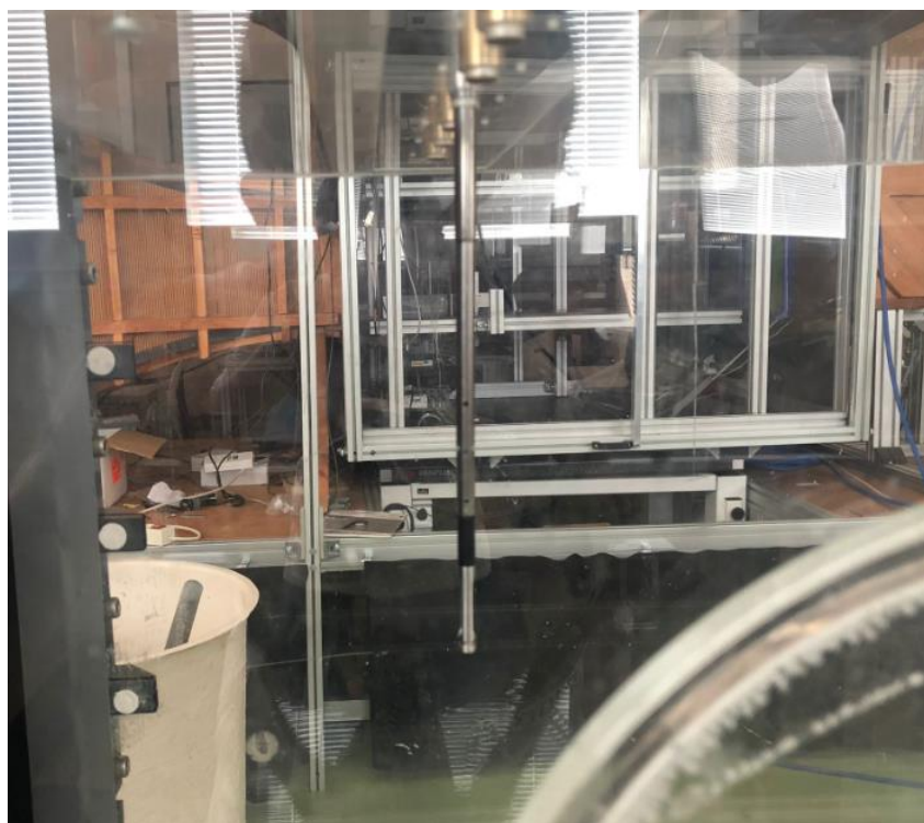
Figura 184. Varilla del anemómetro de hilo caliente en el interior del túnel.
