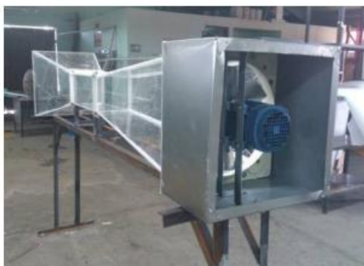
Figura 3. Túnel de viento abierto. (1)
