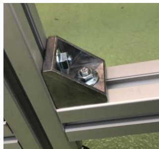
Figura 128. Conexión de barras con escuadras.
