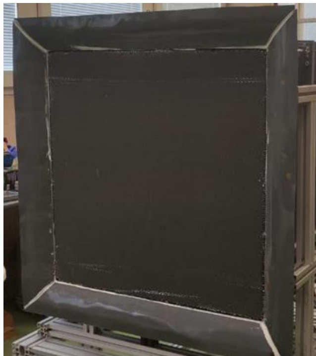
Figura 138. Honeycomb introducido en la entrada.
