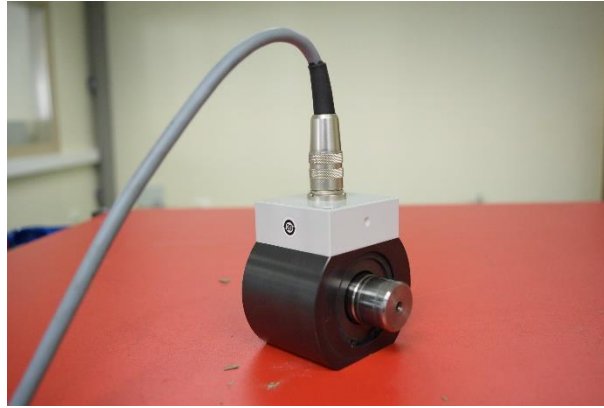
Imagen 33 Medidor Par Máquinas Eléctricas. Fuente: Elaboración propia
