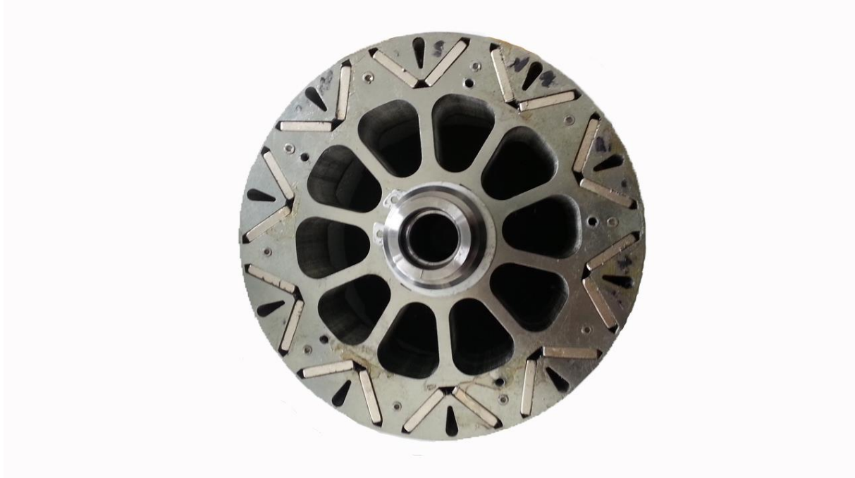
Imagen 12. Rotor del ME - MS1718. Fuente: MotoStudent
