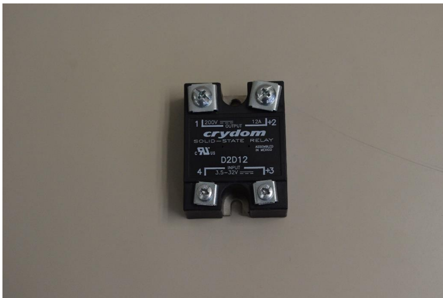
Imagen 53 Relé de estado sólido normalmente abierto. Fuente: Elaboración propia.
