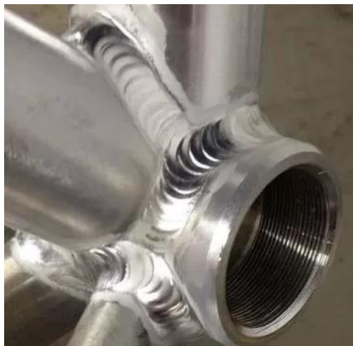
Ilustración 32, Ejemplo de soldadura en aluminio
