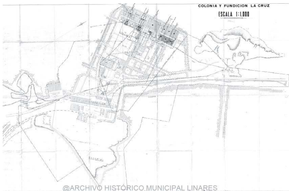
Fig. 5. Plano de la colonia y fundición de La Cruz (A.H.M.L, 1988, legajo 0213 - 097). En la zona norte se ubican las viviendas con abastecimiento de agua potable y electricidad para la colonia.
