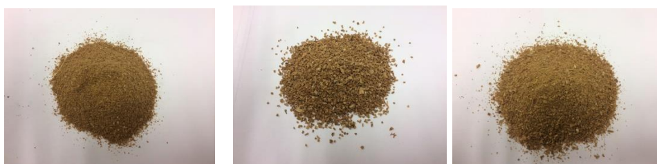
Figura 5. Cáscara de almendra con distinto tamaño de partícula (0/1mm; 1/2mm; 0/2mm; respectivamente).
