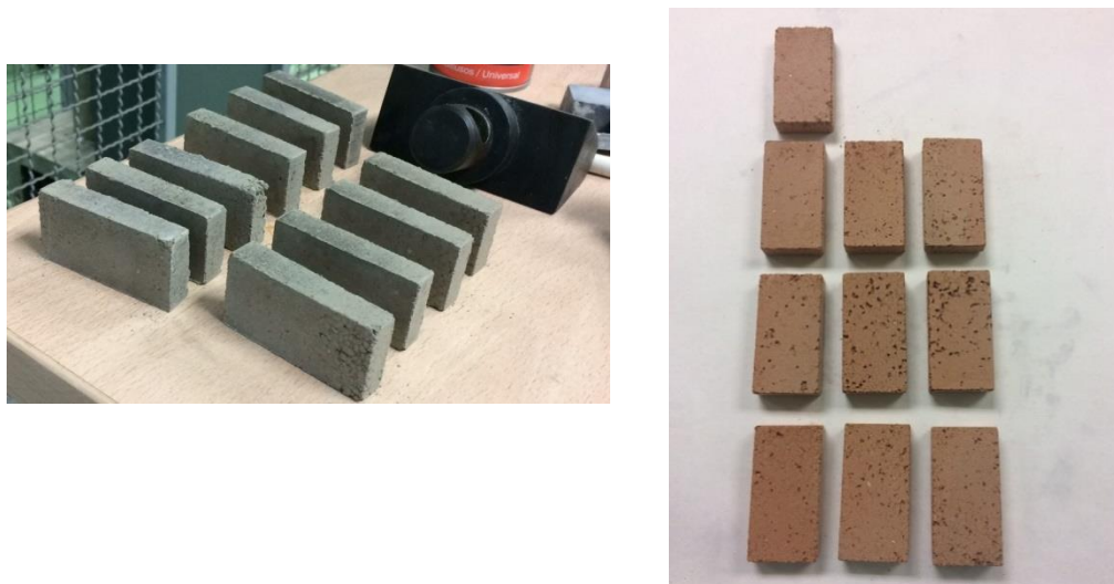
Figura 13. Probetas antes y después del proceso de cocción.
