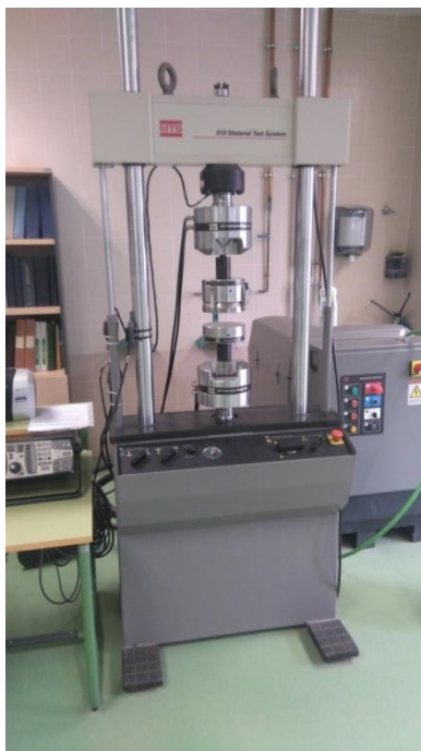
Figura 9. Prensa para ensayo de resistencia a compresión. MTS 810. Material Test System.
