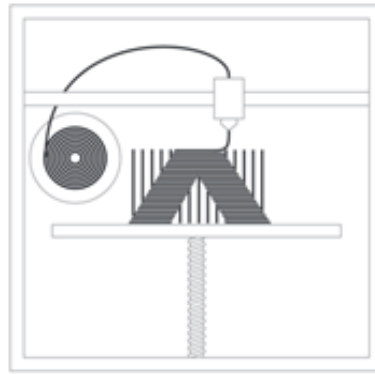
Ilustración 19: Proceso de deposición de material fundido.
