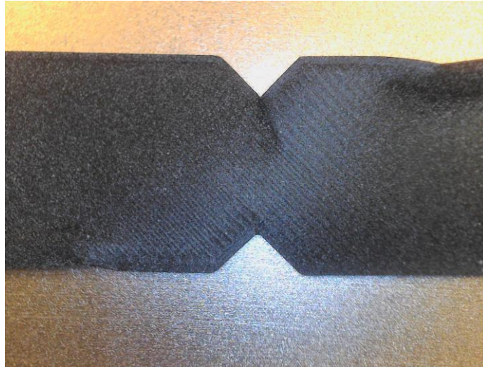
Ilustración 107: Probeta de ensayo a cortante deformada por la pestaña.
