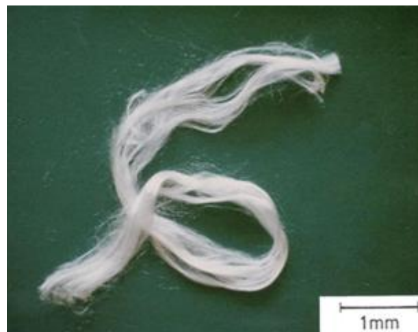
Ilustración 14: Forma final de la fibra de vidrio.
