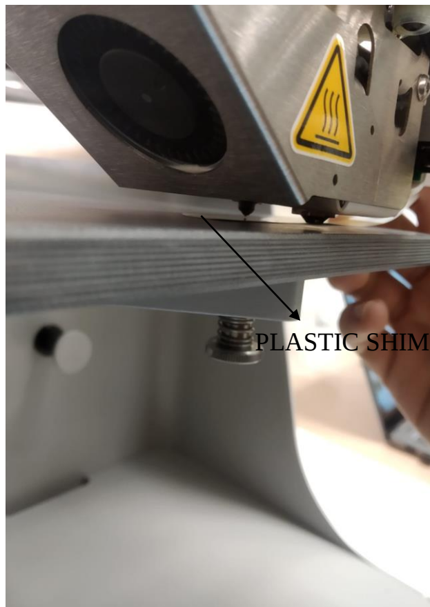
Ilustración 117: Colocación de la cuña bajo el extrusor de plástico.
