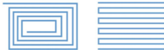
Ilustración 17: Patrón concéntrico a la izquierda, patrón isotrópico a la derecha.
