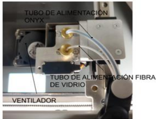
Ilustración 25: Vista superior del extrusor.
