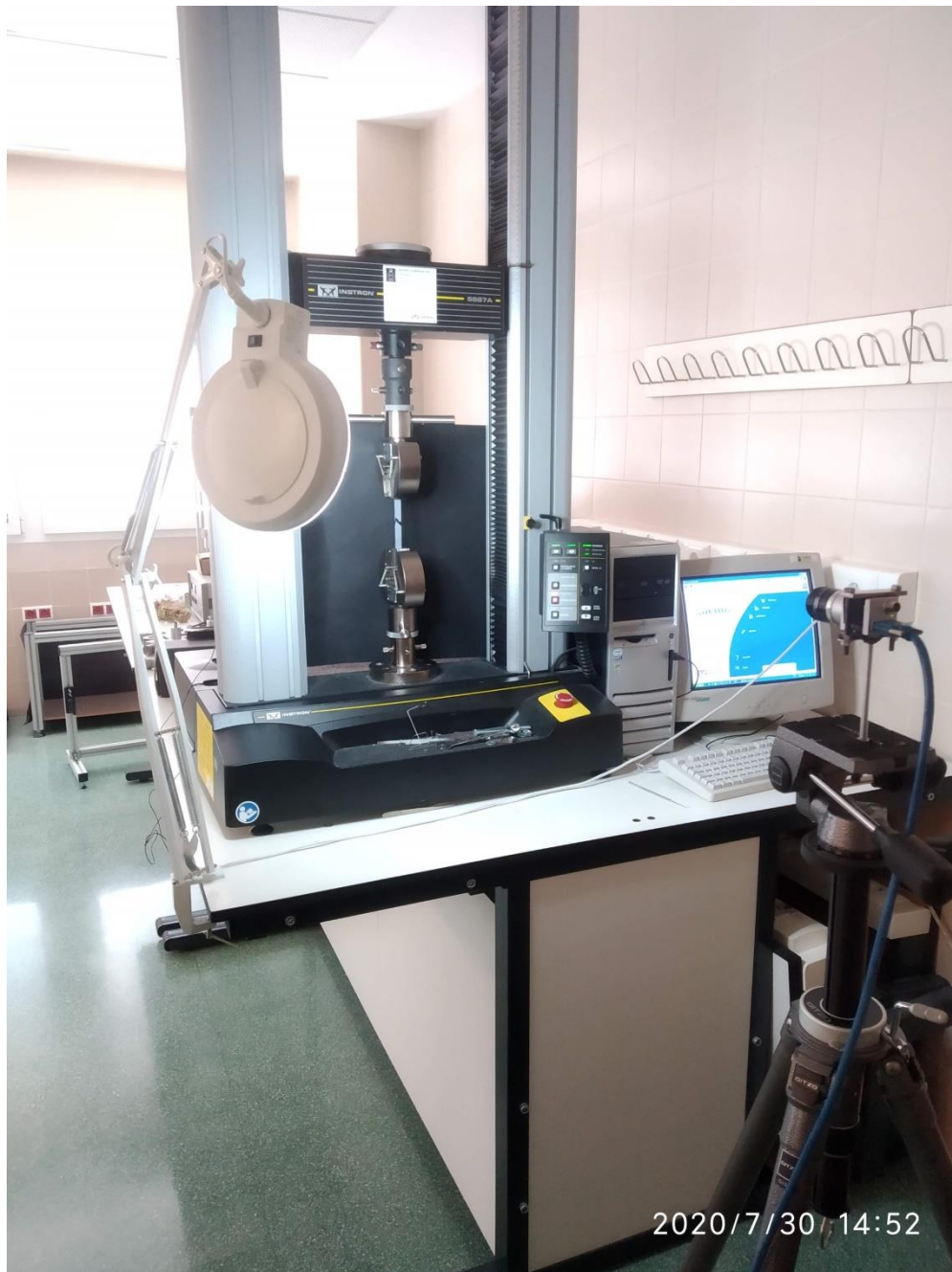
Ilustración 61: Montaje completo del ensayo a tracción.
