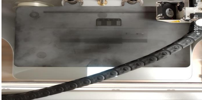
Ilustración 122: Carcasa impresa sobre la bandeja de impresión.
