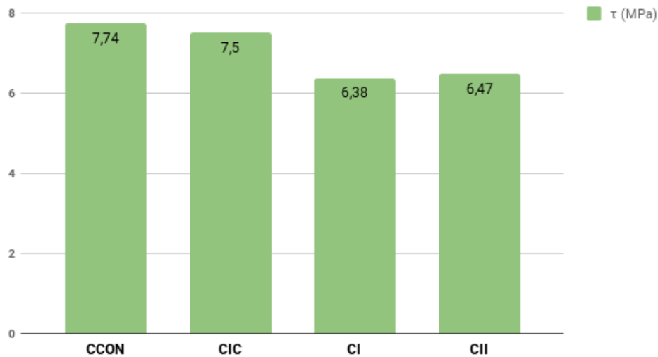
Ilustración 97: Comparación de la tensión máxima.
