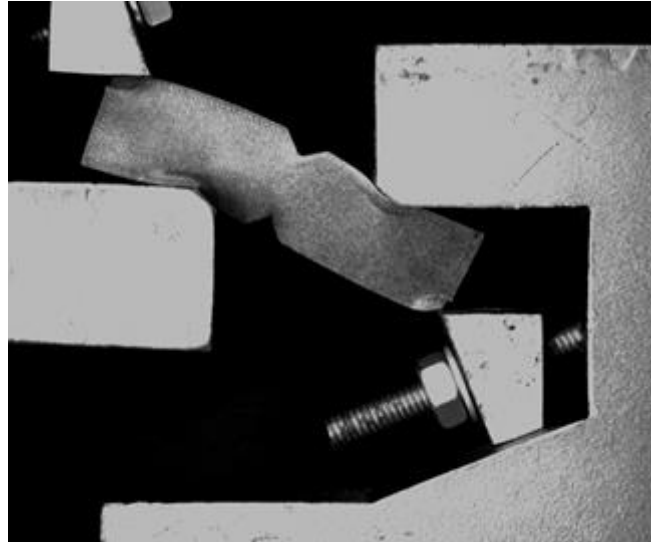
Ilustración 89: Probeta en su posición de máxima deformación.
