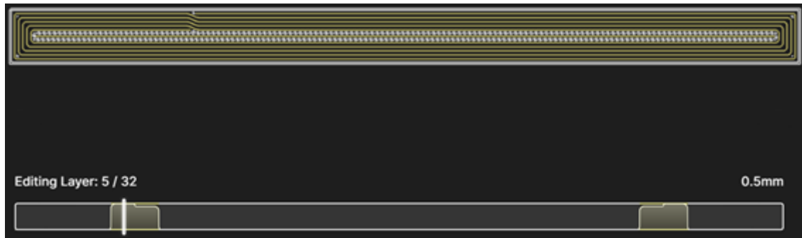
Ilustración 56: Patrón isotrópico, capas de fibra de vidrio contiguas, capa a 0°.
