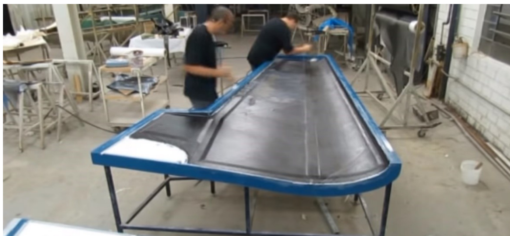
Figura 9, ejemplo de fabricación de un ala para aviación con fibra de carbono
